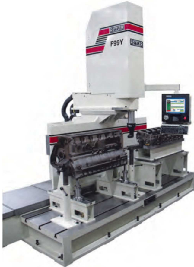
Obrázek 3: Princip zdvojeného pracovního prostoru (Rattler) [5]
