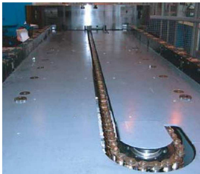
Obrázek 11: Přesouvání palety pomocí řetězu a čepu [5]
