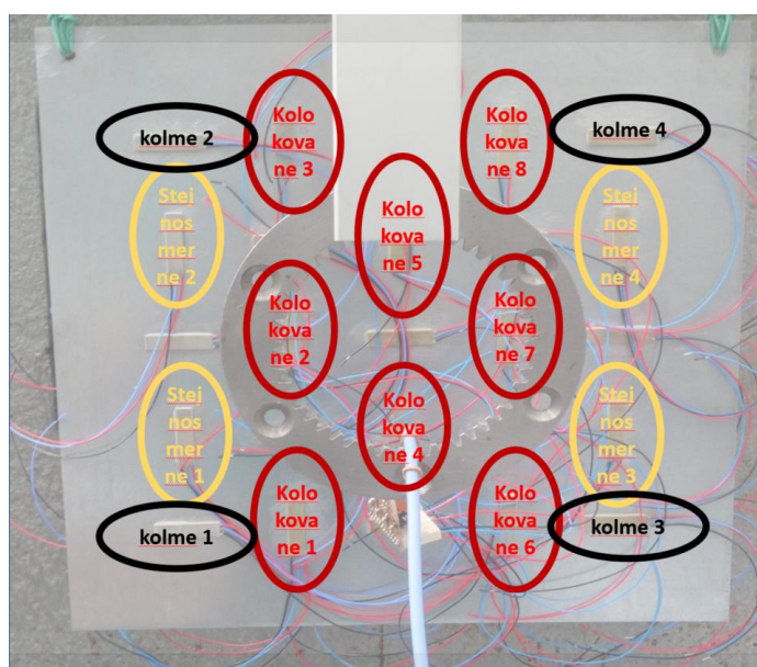
Obr. 90. Rozložení použitých senzorů při experimentu
