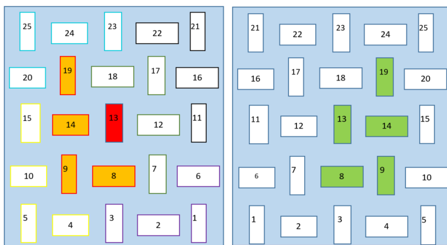
Obr. 48. Rozložení aktuátorů a senzorů použitých pro lokální návrh.
