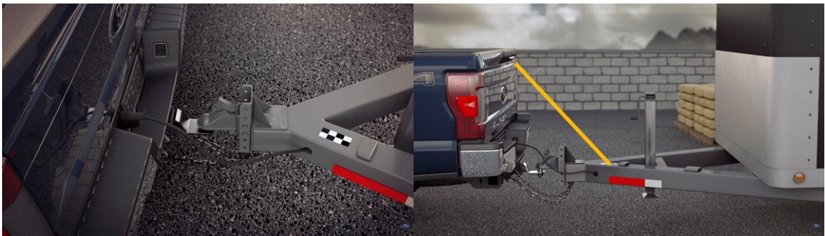
Obr. 3 – Šachovnicová nálepka umístěná na oji přívěsu (převzato z [5])
