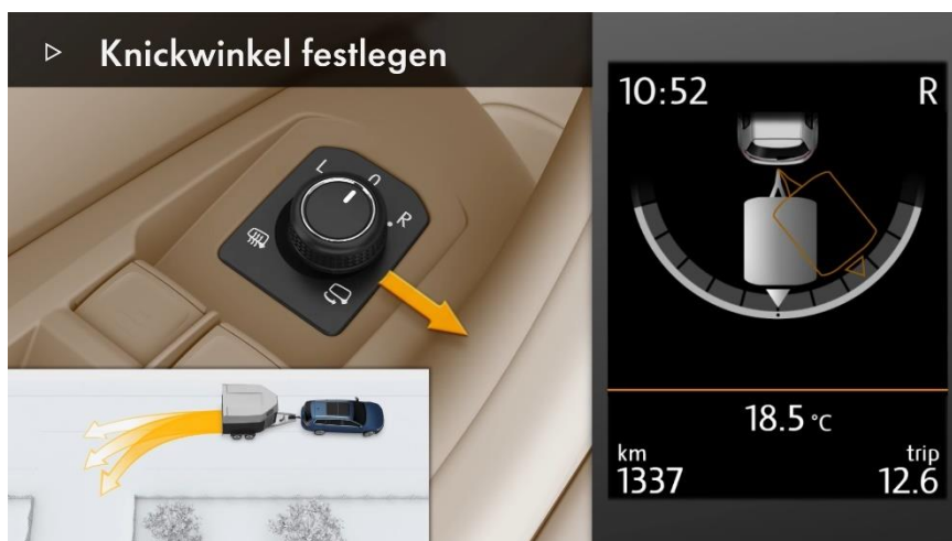
Obr. 2 – Ukázka funkce systému Trailer Assist (převzato z [3])
