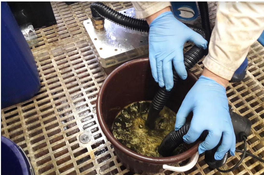
Obr. 9.13 Přečerpávání 5 % kyseliny dusičné.
