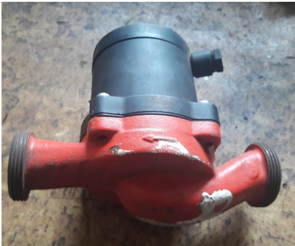
Obr. 9.7 Teplovodné čerpadlo KSB RIO C 25 – 40.
