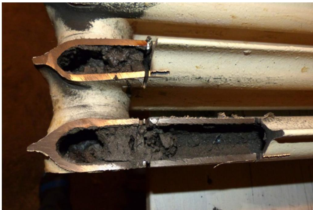
Obr. 2.1 Ukázka řezu zaneseného litinového radiátoru. [4]
