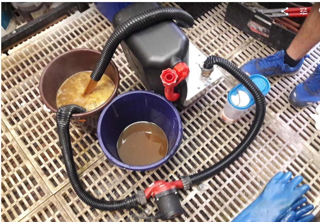
Obr. 9.12 Čerpací okruh se směsí persíranu sodného a peroxidu vodíku.
