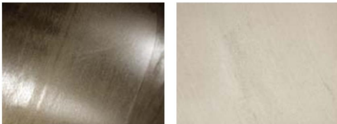
Obr. 5.1 Nalevo povrch korozivzdorné oceli s okujemi, napravo již odokujený a odmořený tentýž povrch. [19]
