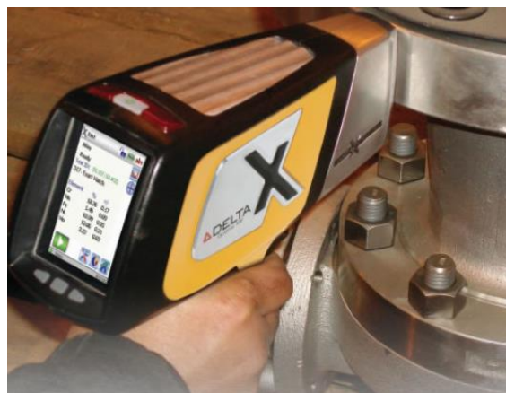
Obr. 8.7 Ukázka měření složení materiálu na přírubě pomocí ručního spektrálního analyzátoru Delta. [32]
