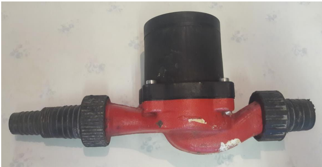
Obr. 9.9 Těleso čerpadla s našroubovanými plastovými přechodkami.
