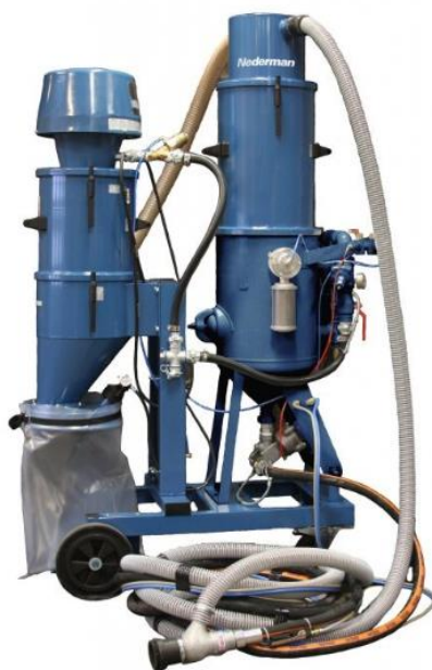
Obr. 4.1 Mobilní otryskávací zařízení. [15]
