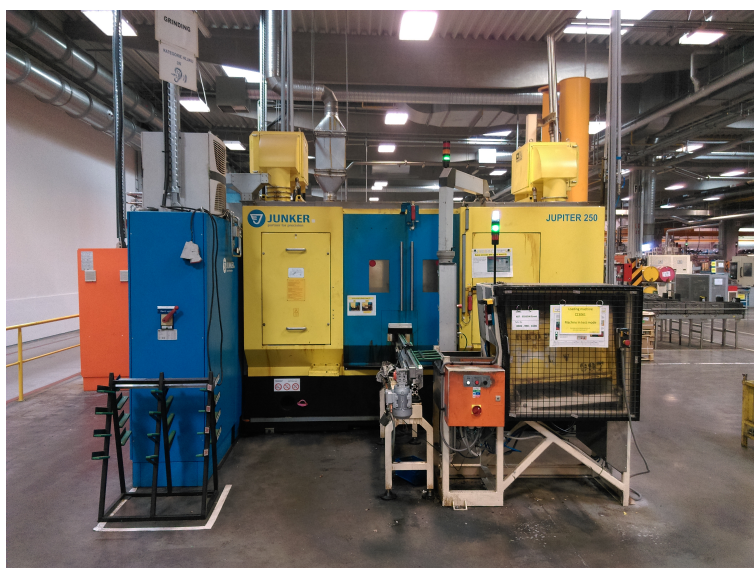
Obrázek 3.5: Bezhrotá bruska značky Junker, typ Jupiter 250
