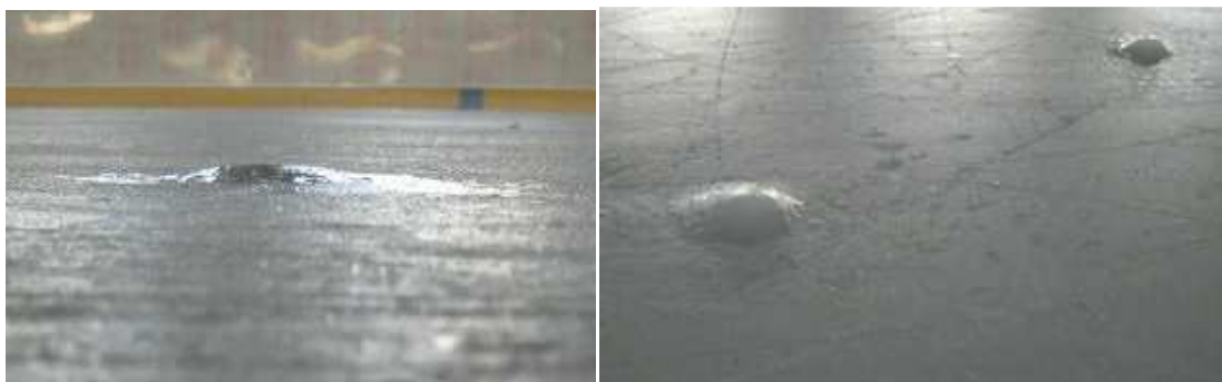
Obr. 2.2. „Krápníkový efekt“ na ledové ploše kluziště [6]
