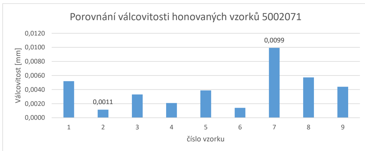
Obrázek 26 - Graf porovnání válcovitosti honovaných vzorků 5002071 vycházející z tabulky 6
