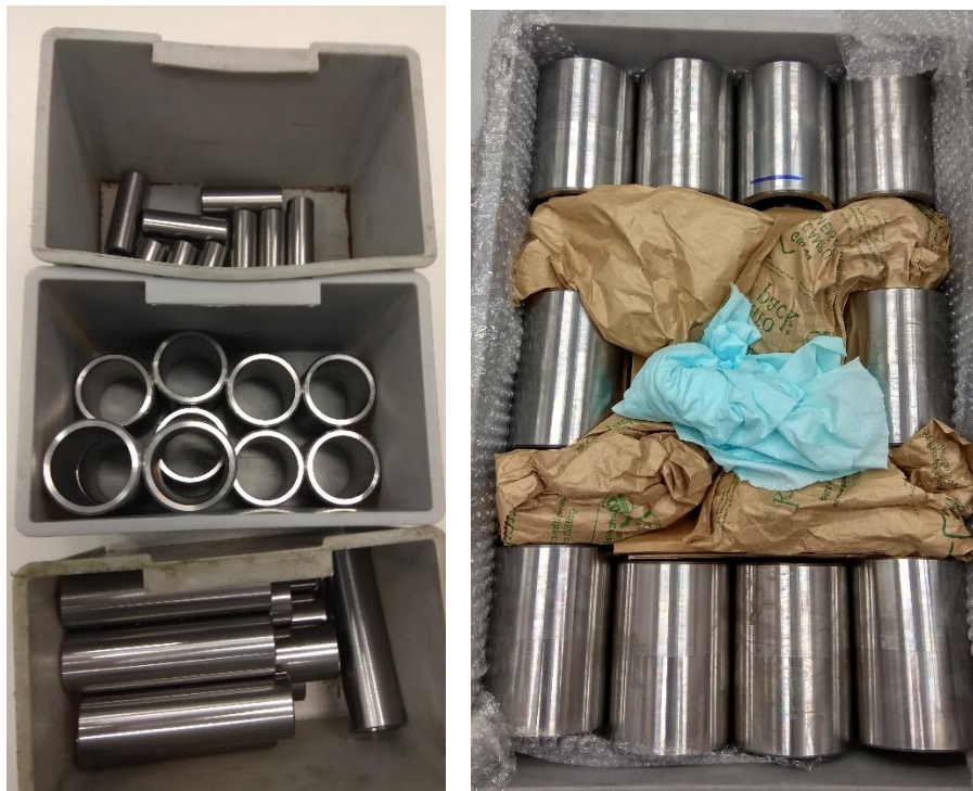
Obrázek 13 - příchozí stav dílů po soustružení
