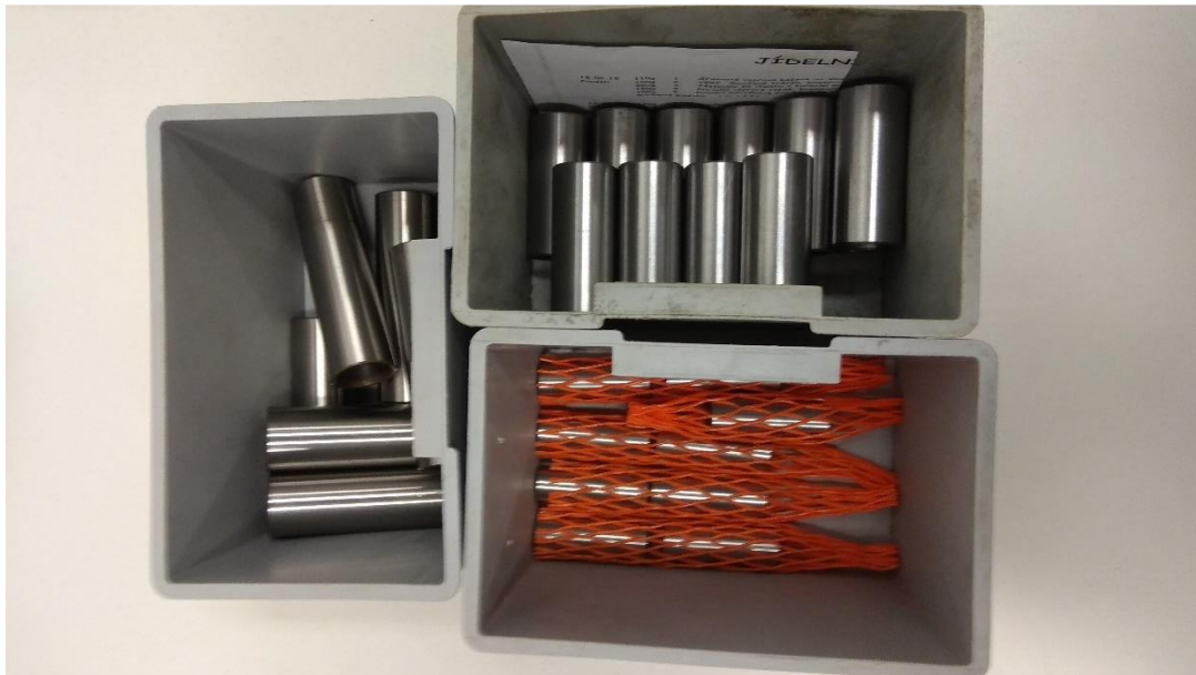
Obrázek 15 - Stav dílů po honování (foto s navíc poslanými díly)
