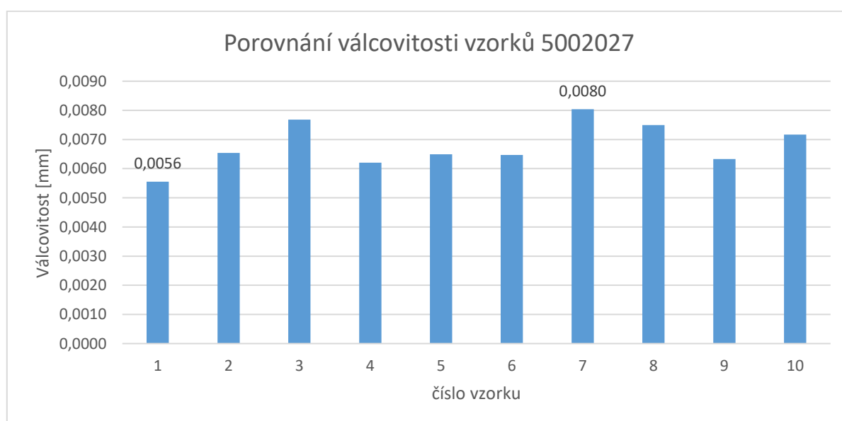
Obrázek 43 - Graf porovnání válcovitosti vzorků 5002027 vycházející z tabulky 11
