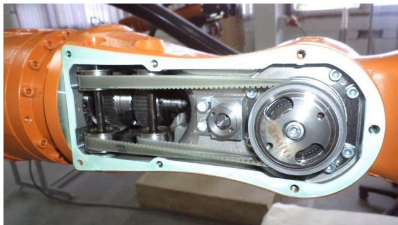
Obr. 11 – Pohon 5. a 6. osy robotu KR5 od firmy KUKA [14]
