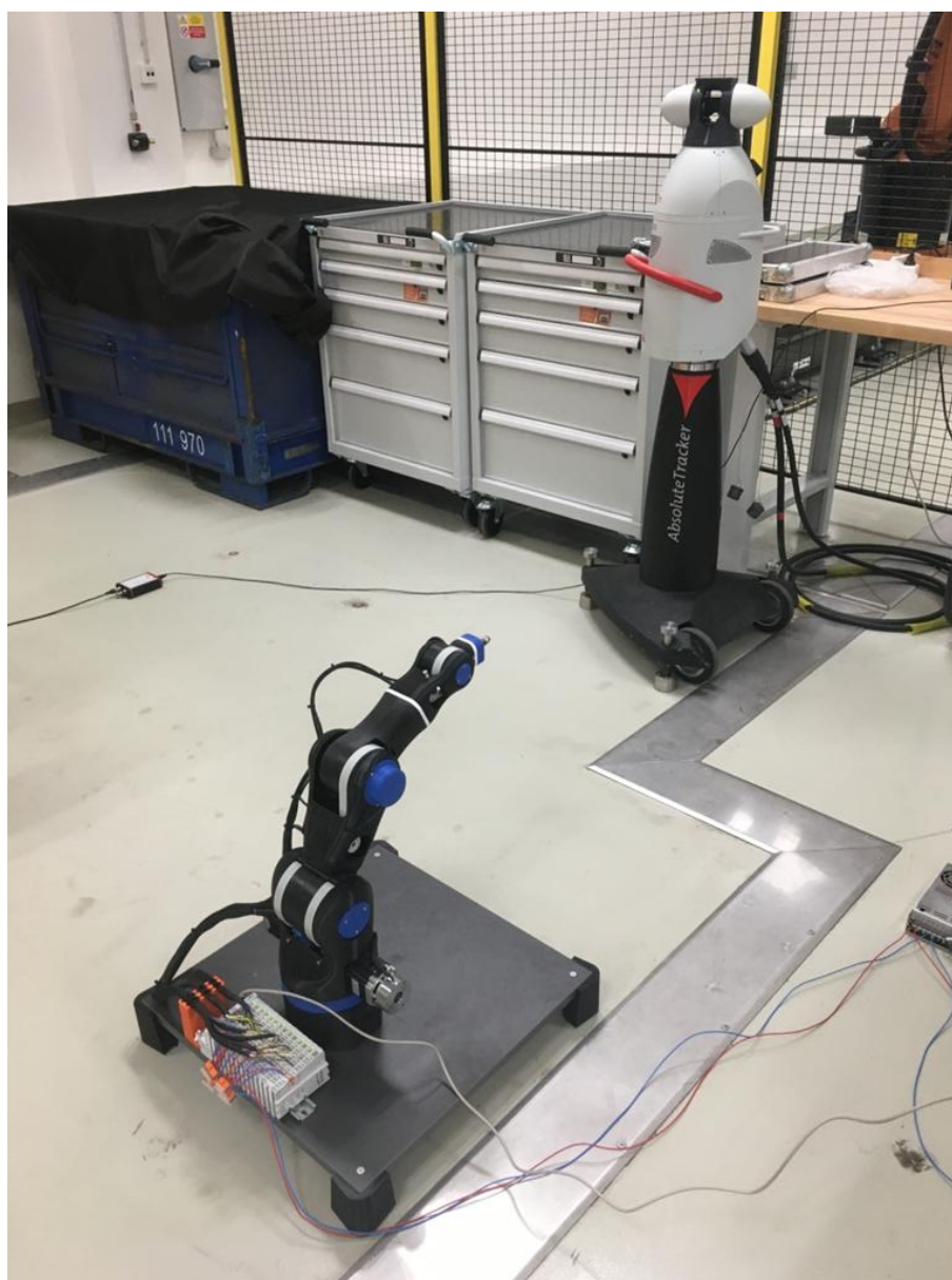
Obr. 63 – Měření přesnosti laser trackerem
