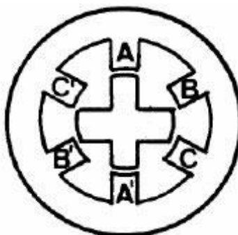
Obr. 13 – Princip krokového motoru s variabilní reluktancí [17]
