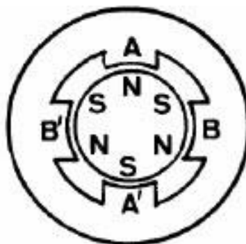
Obr. 14 – Princip krokového motoru s permanentním magnetem [17]
