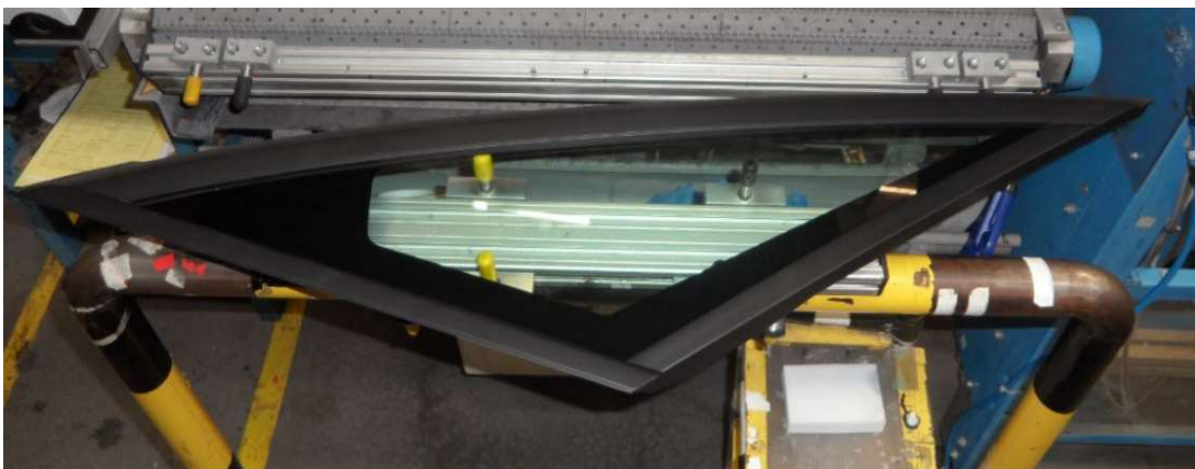
Obr. 27 – Vyrobené autosklo – strana A (pohledová)
