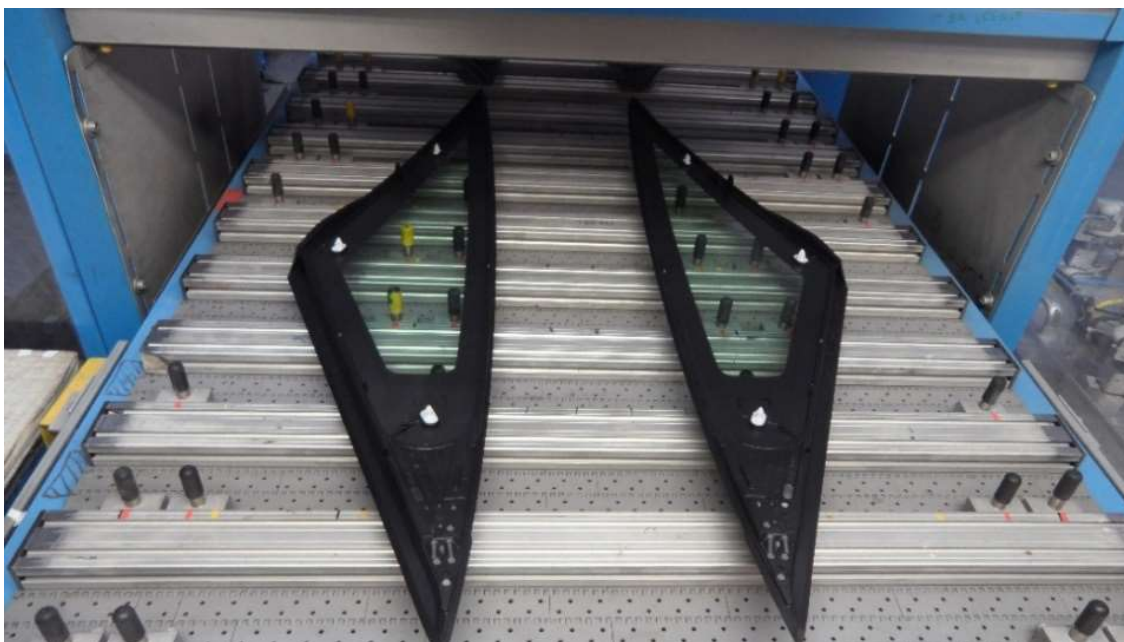
Obr. 26 – Vyrobená autoskla - strana B (nepohledová)
