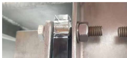
Obrázek 4.7 Praskliny, PMMA deska (b)
