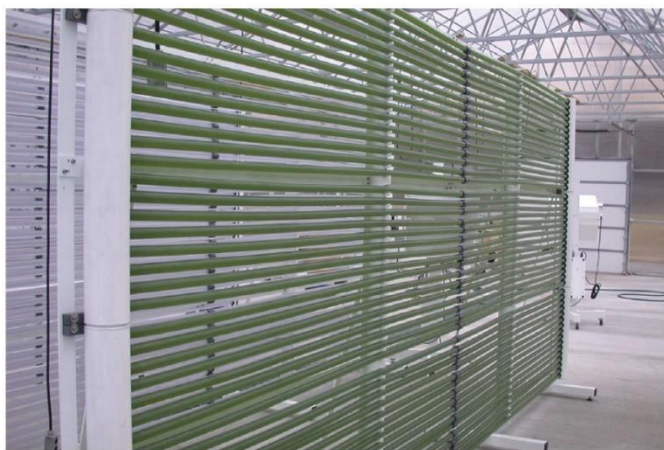
Obrázek 1.2 Trubkový fotobioreaktor (Greenwell et al., 2010)
