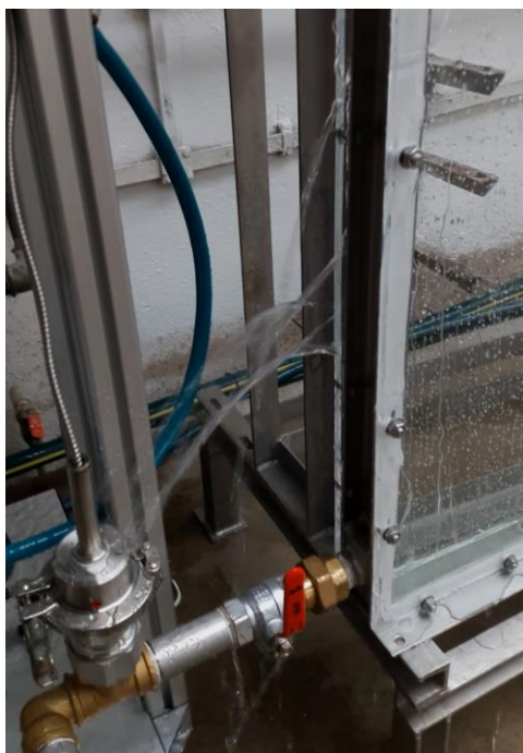
Obrázek 3.2 Fotobioreaktor, původní návrh, netěsnosti
