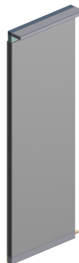
Obrázek 5.16 Fotobioreaktor geometrie, Ansys (Červený, 2018a)
