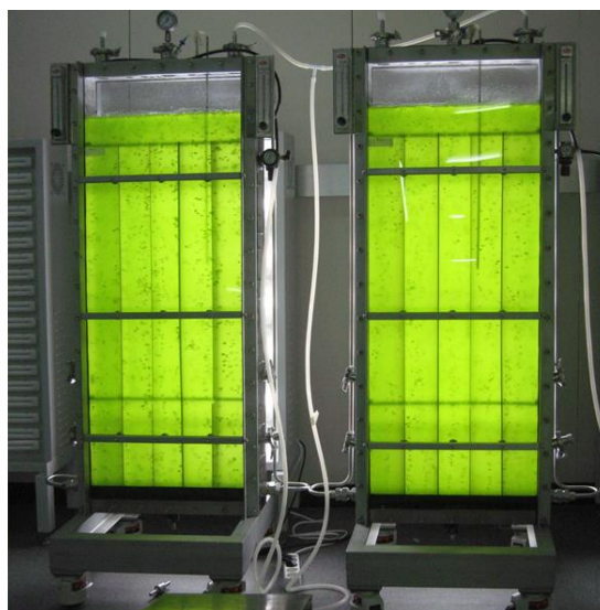
Obrázek 2.21 Příklad vnějších vyztužovacích prvků (Doga limited, 2018)
