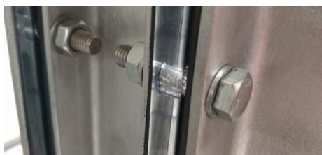
Obrázek 4.6 Praskliny, PMMA deska (a)
