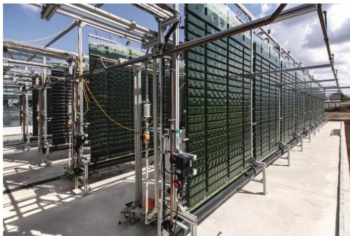
Obrázek 1.3 Deskový fotobioreaktor (Bělohav et al., 2017)
