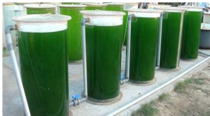
Obrázek 1.4 Válcový fotobioreaktor (Bělohav et al., 2017)
