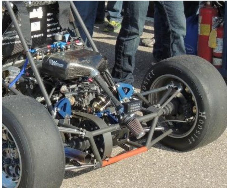
Obr. 18: Sací trakt se vstupem vzduchu ze zadní části vozu [13]
