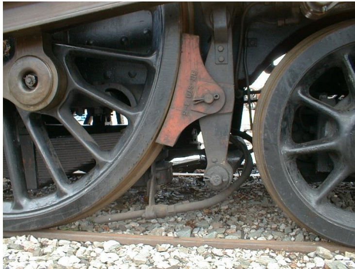
Obrázok 1.1-2 Vyobrazenie typu špalíkovej brzdy na parnej lokomotive 70000 Britannia [2]
