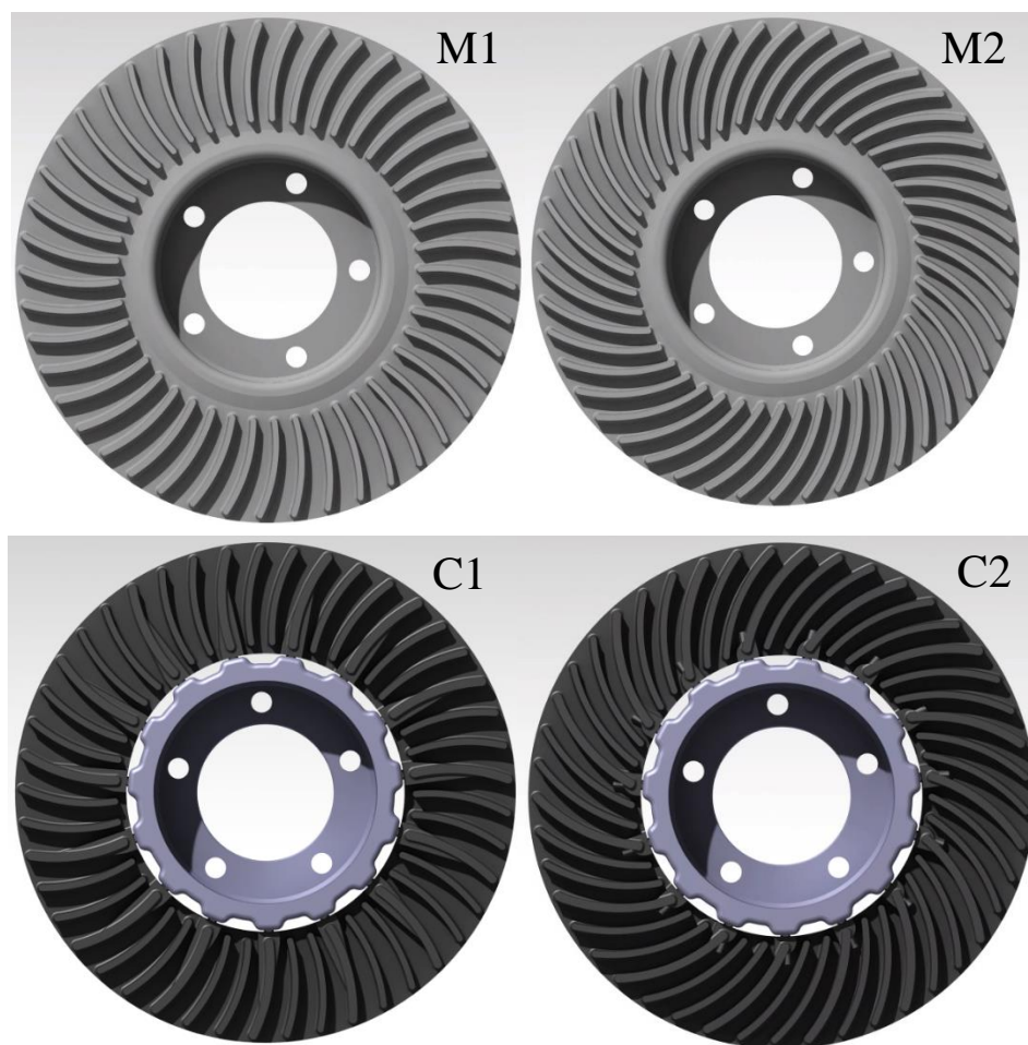
Obrázok 2.4-4 Zobrazenie monolitov M1 M2 v hornej časti a čapových diskov C1 C2 v dolnej časti s polomerom rebra 120mm a uhlovými výsekmí 5 stupňov M1, C1 a 20 stupňov M2, C2 sprava doľava
