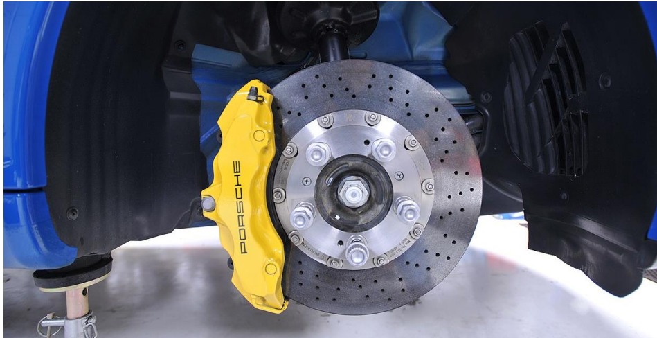
Obrázok 1.1-4 Skrutkovaný keramický brzdový kotúč vozidla Porsche Carrera S [4]
