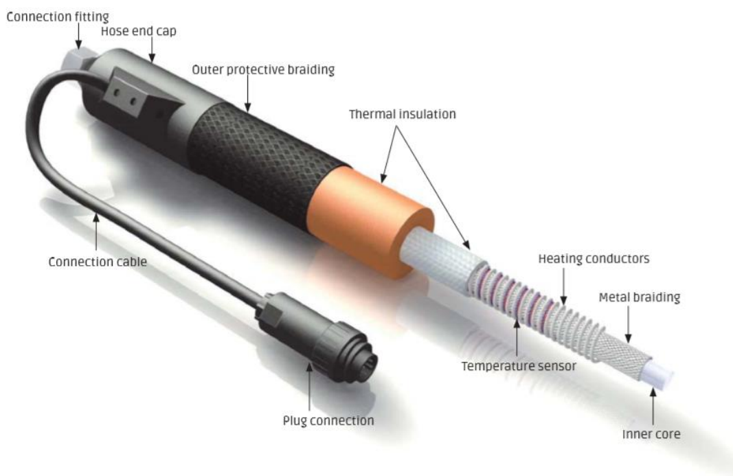
Obr. 17 Průřez otápěnou hadicí [17]
