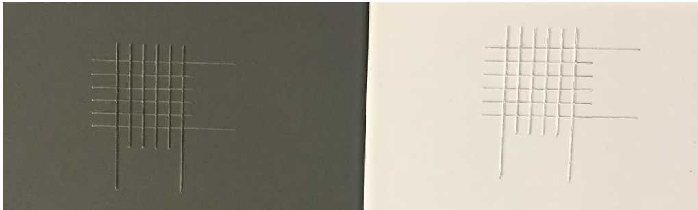
Obr. 35: Mřížková zkouška pro LNS+PU (šedivá vlevo) a LNG-NG+PU (bílá vpravo) s mřížkou 3mm.
