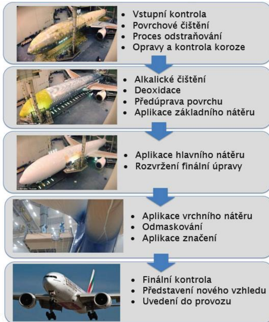
Obr. 15: Jednotlivé kroky potřebné při aplikaci nového systému povrchové úpravy letadla [3].
