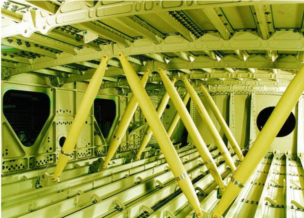
Obr. 10: Příklad aplikace vnitřního nátěrového systému letadlové konstrukce [3].
