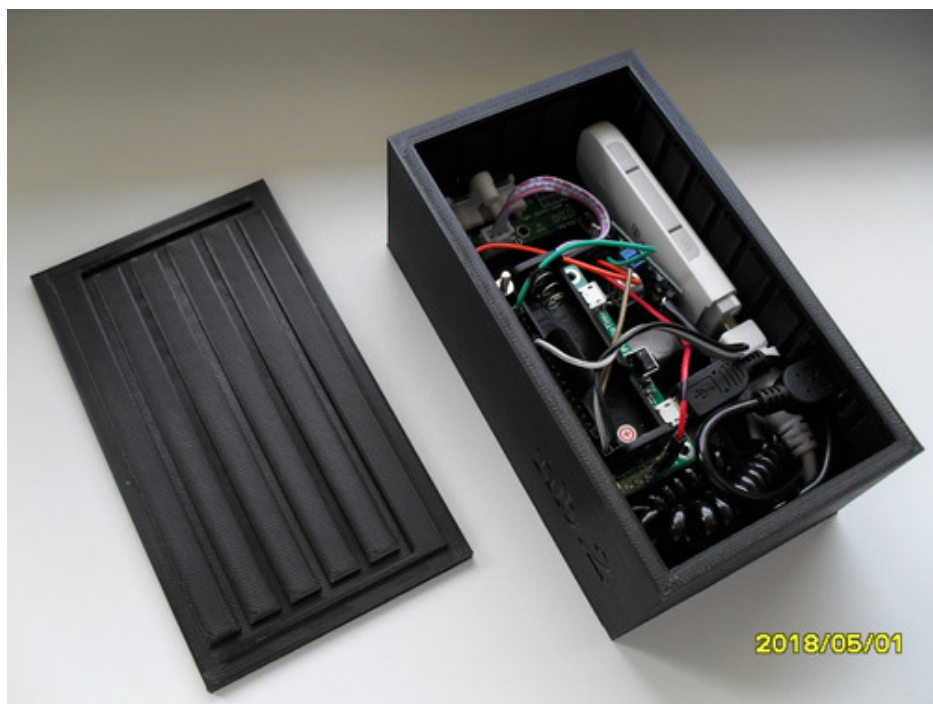
Obrázek A.1: Zvukový senzor v plastovém obalu bez vodiče ve stěněch.
