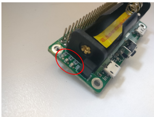
Obrázek 3.2: Stavové diody modulu PiZ-UpTime.
