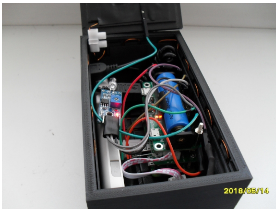
Obrázek A.4: Hardware zvukového senzoru.
