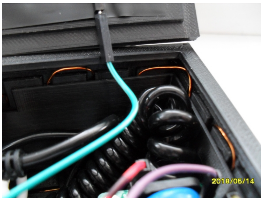
Obrázek A.5: Detail vodiče ve stěnách plastové krabičky.
