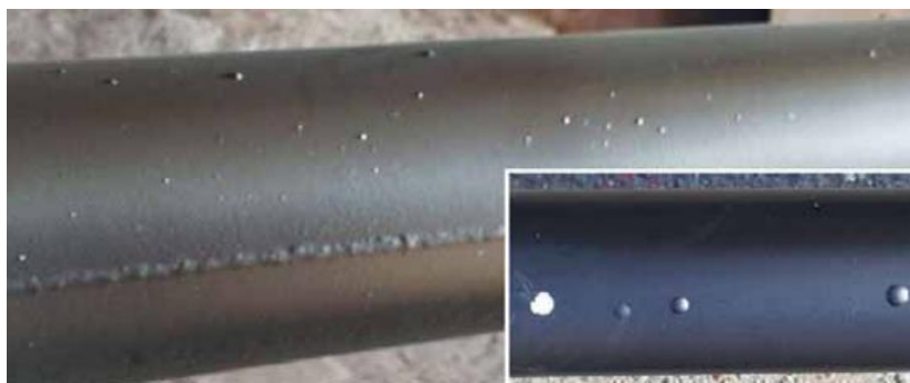
Obrázek 12: Vada vzniklá v nátěru [31]
