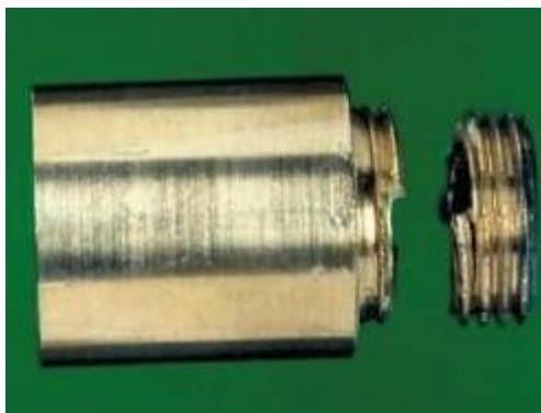
Obrázek 11: Příklad vodíkové křehkosti [21]
