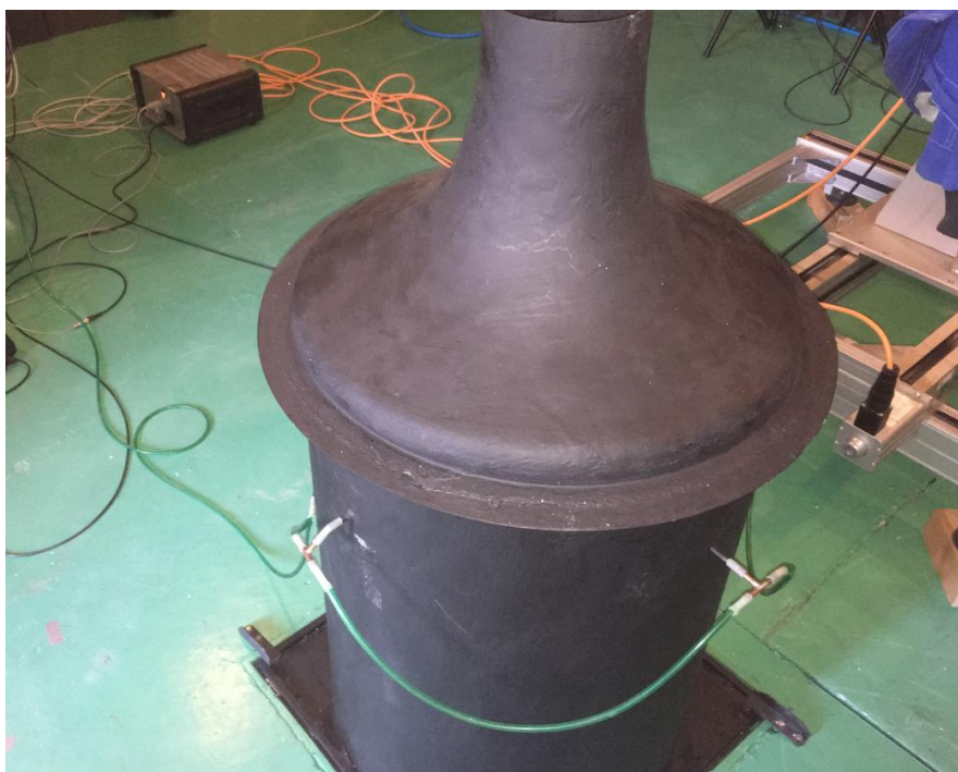
Obr. 2-6 Odběrná místa statického přetlaku (zelená hadička)
