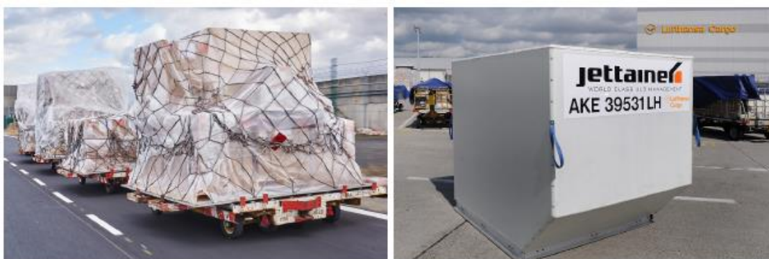
Obr. 4: Naložená paleta PMC (vlevo). AKE kontejner (vpravo). (Zdroj: Lufthansa Cargo AG)
