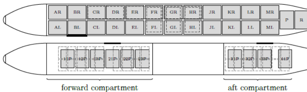
Obr. 14: Rozložení nákladových pozic nákladního letadla MD11F (Zdroj: The Air Cargo Load Planning Problem, Felix Branddt)
