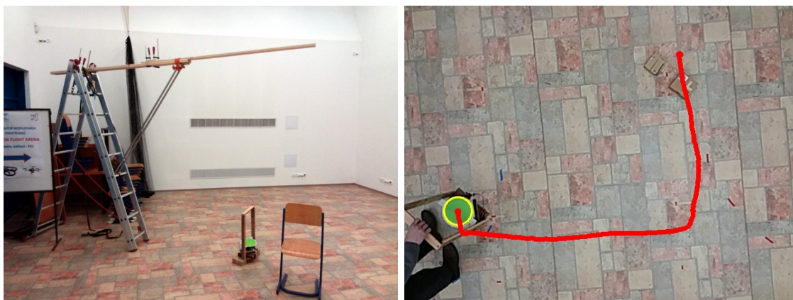
Obrázek 5.4: Vlevo: navigační systém se zelenou značkou a konstrukce pro upevnění kamery; vpravo: snímek z nahraného videa během zpracování algoritmem z [31]
