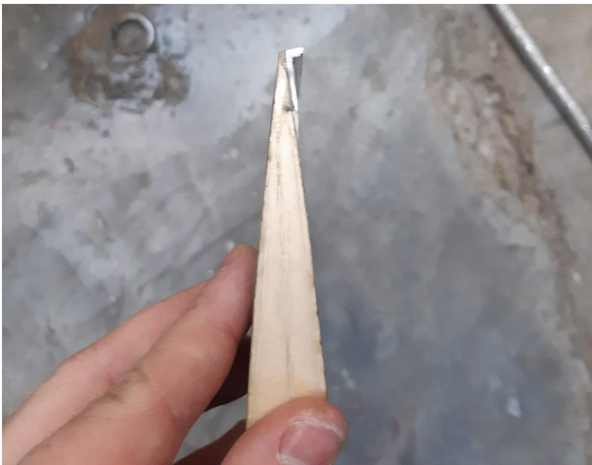
Obr. 27 - Model s Gurneyho klapkou po vyhlazení
