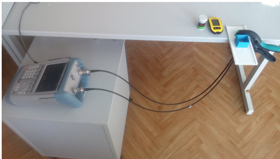
Obrázek 3.2: Propojení vektorového analyzátoru se senzorem a komerční glukometr (žlutý přístroj) pro měření plné krve.
