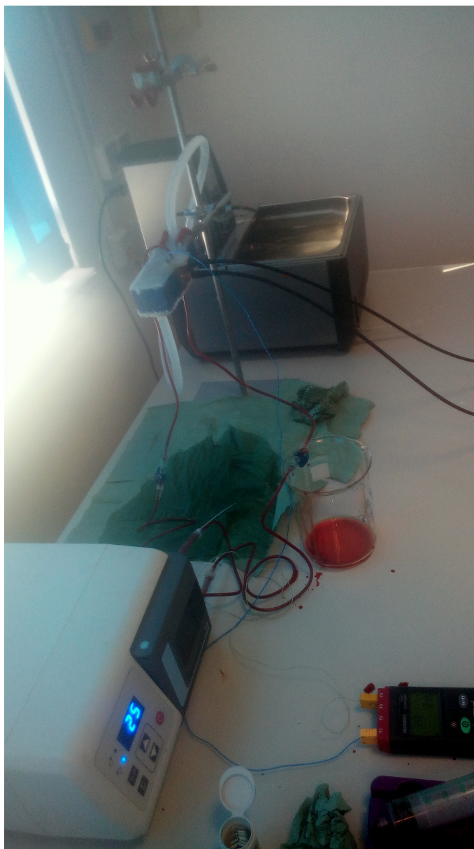
Obrázek 3.6: Zapojená sestava ohřevu a oběhu se vzorkem. Nejblíže je vidět peristaltická pumpa na stojanu samotný prvek se senzorem a nejdál je vodní lázeň.
