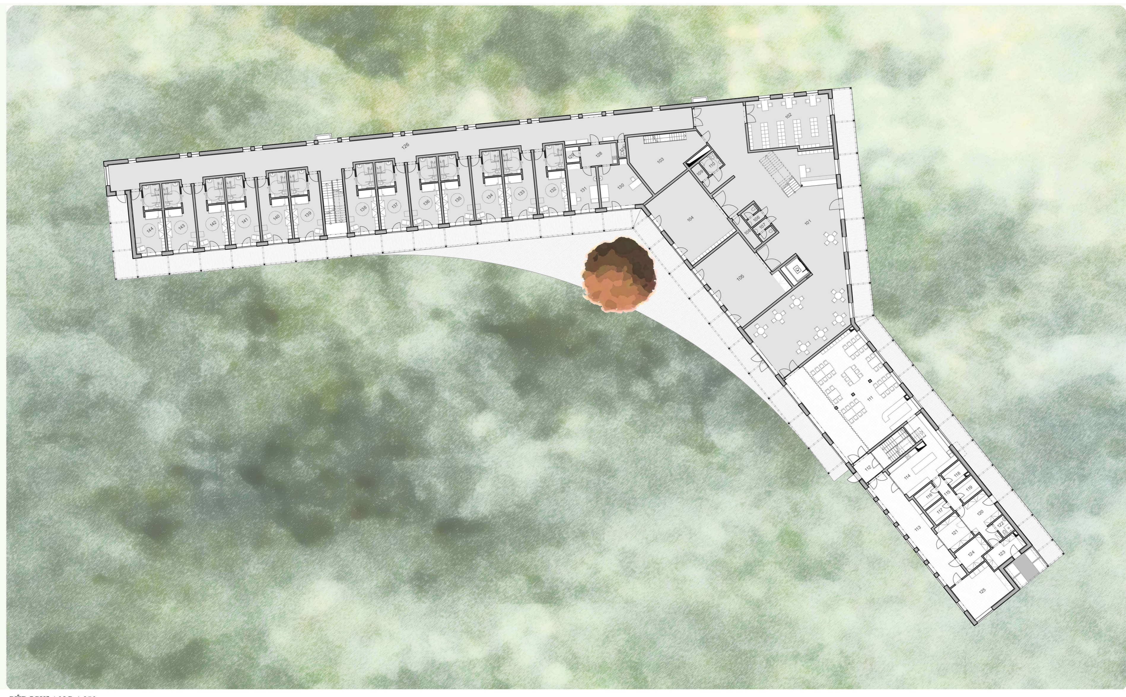
PŮDORYS 2.N.P. 1:250 101 Vstupní hala; 102 Knihovna; 103 Sklad; 104 Sál pro pohybové aktivity; 105 Sál pro tvůrčí činnost; 106 WC; 107 WC; 108 Sklad; 109 Úklidová místnost; 110 WC; 111 Jídelna; 112 Chodba; 113 Chodba; 114 Kuchyně; 115 Chodba; 116 Lednice zelenina; 117 Lednice maso; 118 Sklad jídla; 119 Mrazák; 120 Zádveří; 121 Satna; 122 WC; 123 Sklad odpadů; 124 Sklad; 125 Prádelna; 126 Chodba; 127 WC; 128 Zdravotní sestra; 129 Sklad; 130 Doktor ošetřující; 131 Doktor psycholog; 132 - 144 Pokoj seniorů s vlastní koupelnou - pohybové omezení
