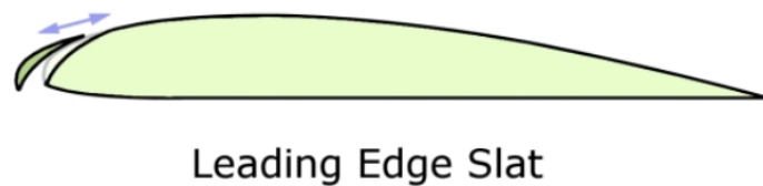
Obr. 2: Pohyblivý slot na náběžné hraně [2]
