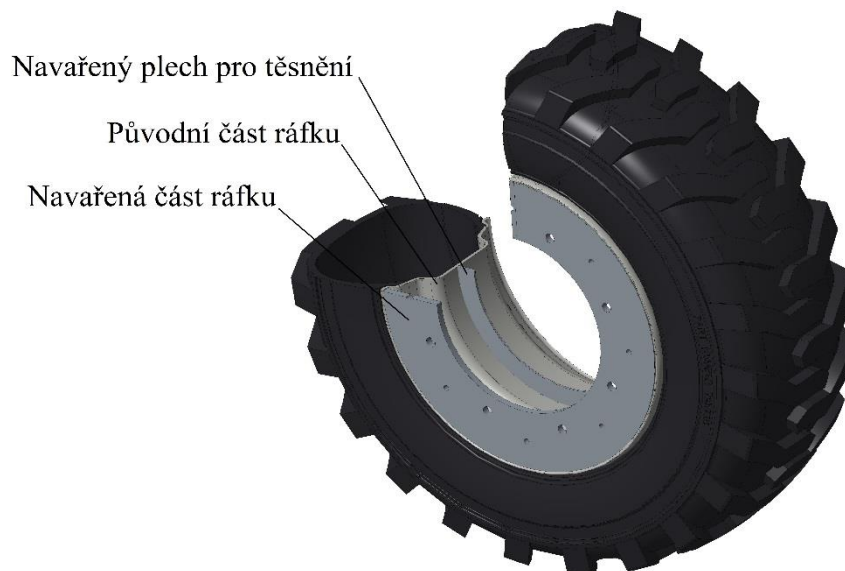
Obr. 93.: Upravený ráfek pro senzor
