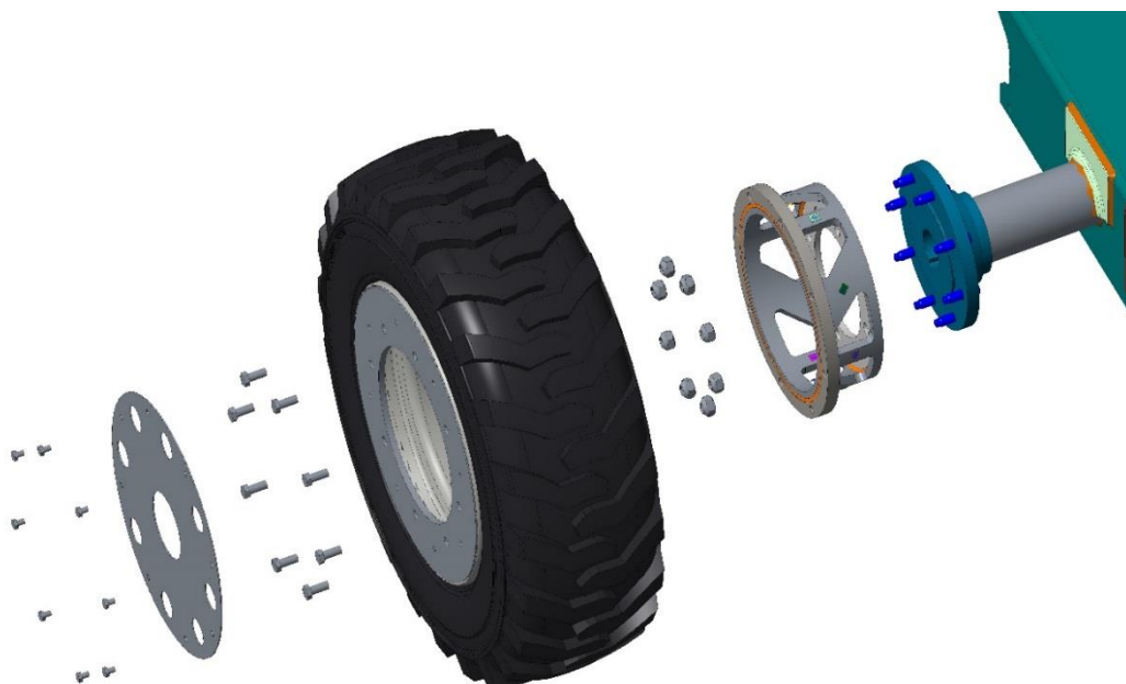
Obr. 97.: Nasazený krycí plech na ráfku
