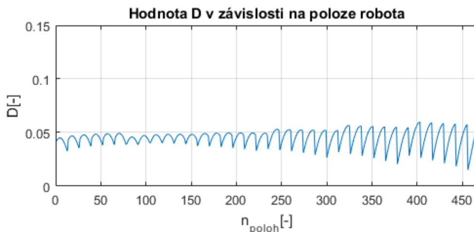
Obr. 42 – Neoptimalizovaná hodnota D ve všech uvažovaných polohách robota
