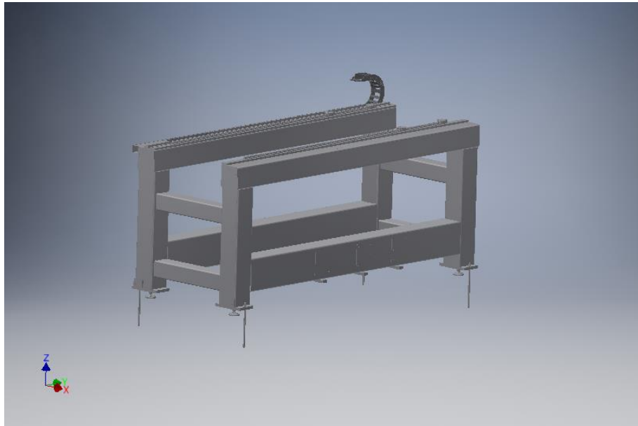
Obr. 3 Portál osy Y, který je umístěn na spodním rámu s válečkovou dráhou
