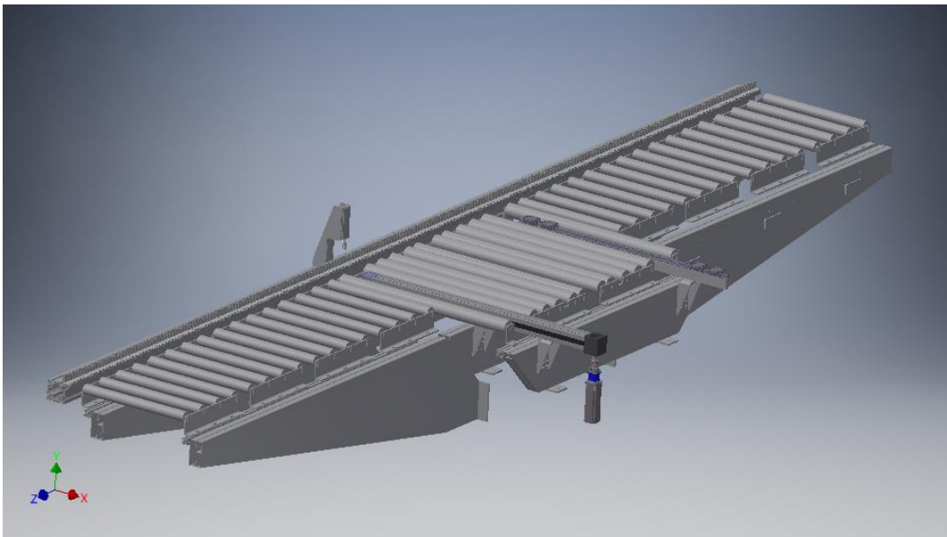
Obr. 2 Válečková dráha obráběcího stroje
