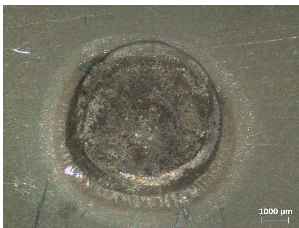
Obr.28 Snímok vtlačku po elektróde po zváraní vhodnými parametrami
