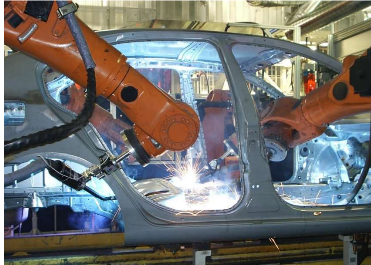
Obr.12 Automatizované zvaracie pracovisko [20]
