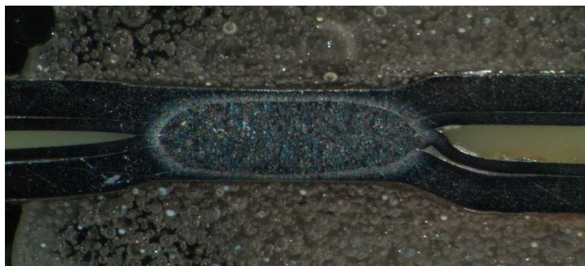
Obr.32 Metalografický výbrus vyhovujúceho zvaru po kontrole ultrazvukom
