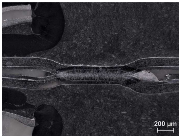
Obr.46 Makroštruktúra zvarového spoja zvaraného parametrami č.32
