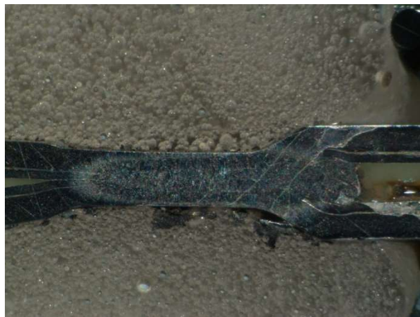
Obr.42 Metalografický výbrus vzorky s nesúmernou deformáciou
