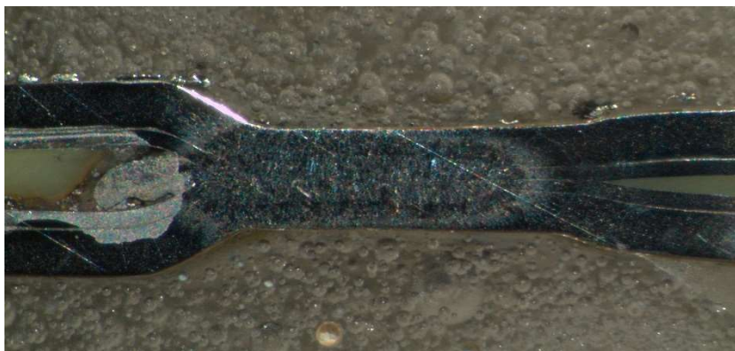
Obr.34 Metalografický výbrus nevyhovujícího zvaru po kontrole ultrazvukom
