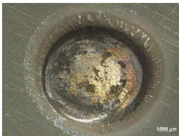
Obr.30 Snímok vtlaku po elektróde po zváraní nevhodnými parametrami
