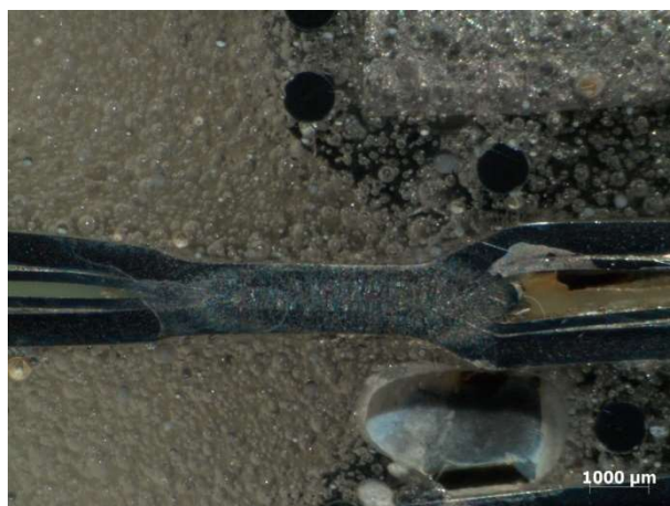
Obr.44 Metalografický výbrus vzorky s vytlačeným polymérovým jadrom
