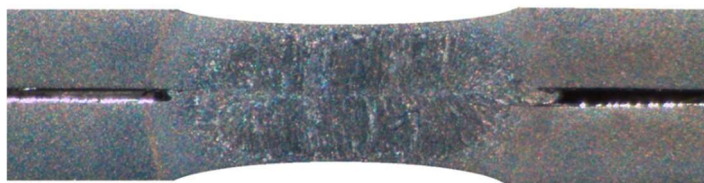
Obr.11 Makroštruktúra bodového zvarového spoja [5]
