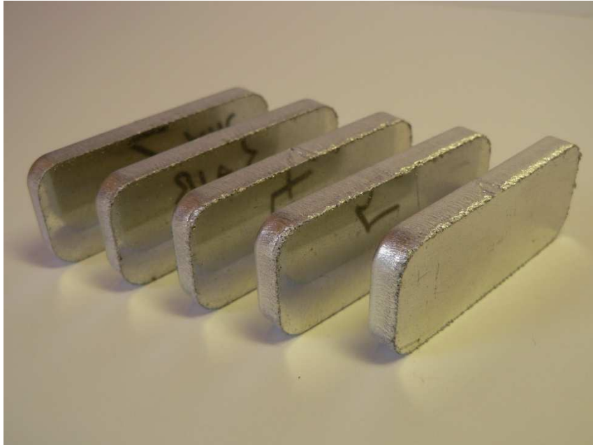
Vzorky z hliníku EN AW-1050A H24 řezané vzduchem
