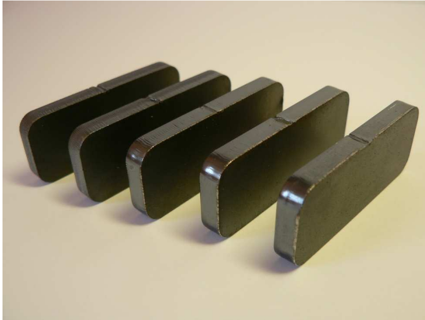
Vzorky z oceli S235JR řezané kyslíkem
