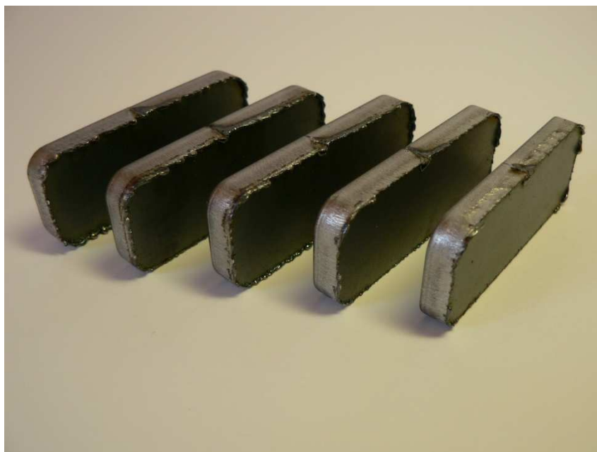
Vzorky z oceli S235JR řezané dusíkem
