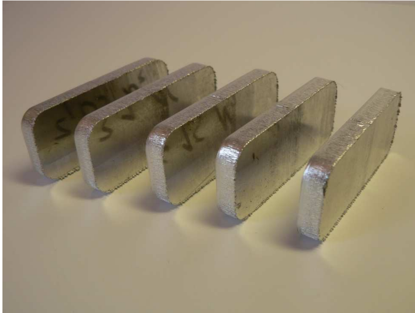
Vzorky z hliníku EN AW-1050A H24 řezané dusíkem
