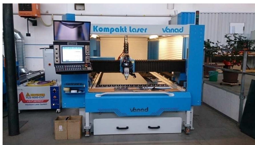
Obrázek 26-Vanad KOMPACT Laser se zdrojem IPG a hlavou Precitec
