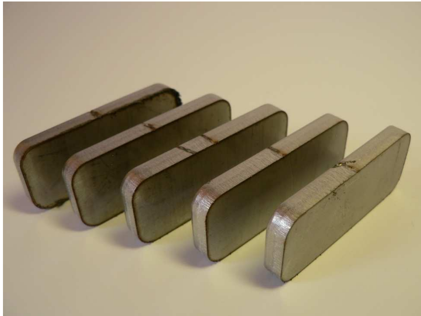
Vzorky z oceli X5CrNi18-10 řezané dusíkem
