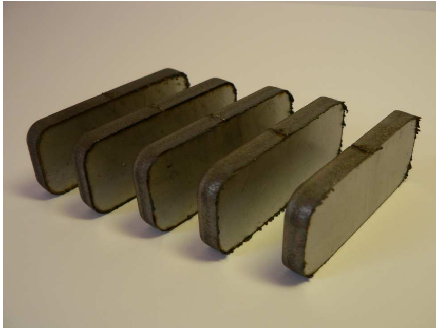
Vzorky z oceli X5CrNi18-10 řezané vzduchem
