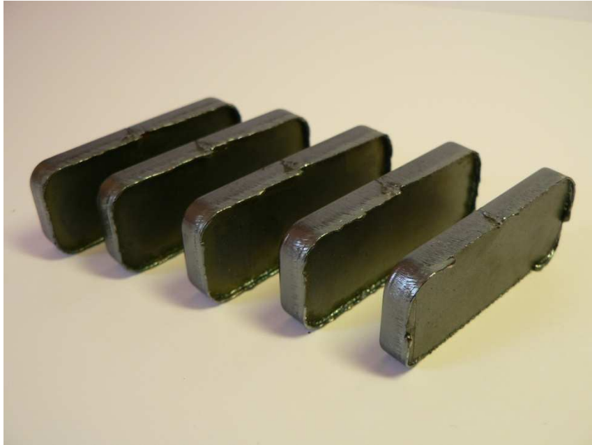
Vzorky z oceli S235JR řezané vzduchem
