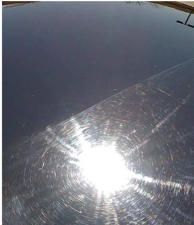
Obr. 10 Nepoškozený lak (vlevo) a lak s vlasovými škrábanci (vpravo) [31]
