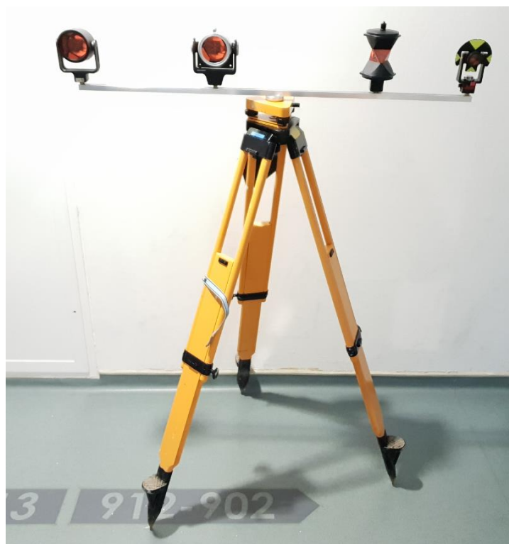
Obr. 11: Hranoly na kovové lati na stativu.
