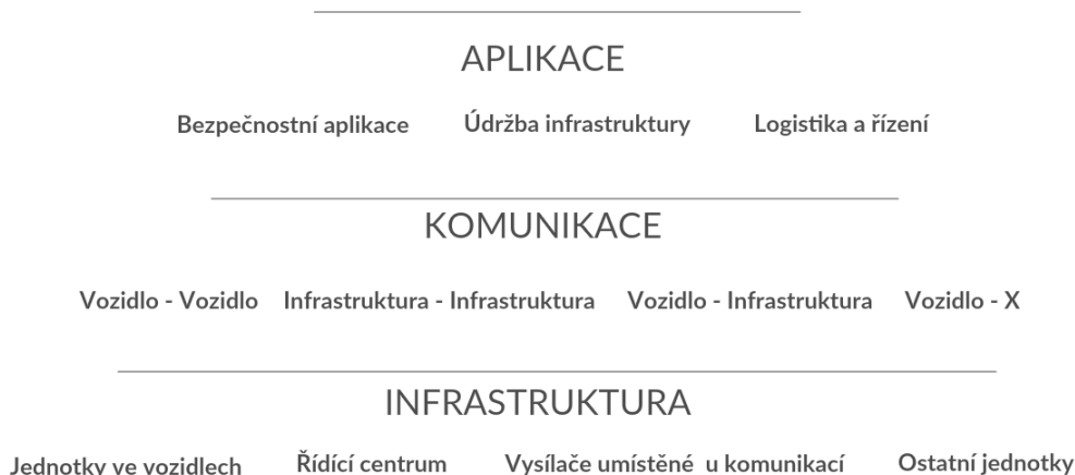
Obr. 1 – Zjednodušené zobrazení C-ITS architektury, zdroj: autor
