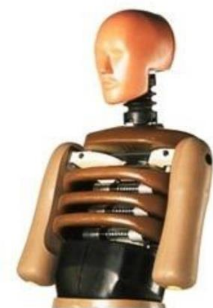
Obr.16 – Ukázka figuríny, detail hrudníku a krku.
