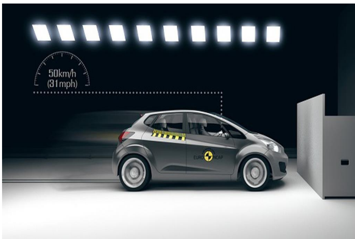
Obr. 11 – Ukázka automobilu při testu EURO NCAP, plný čelní náraz do nedeformovatelné bariéry
