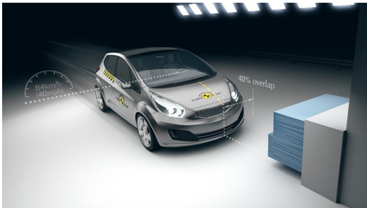
Obr. 10 – Ukázka automobilu při testu EURO NCAP, částečný čelní náraz do deformovatelné bariéry
