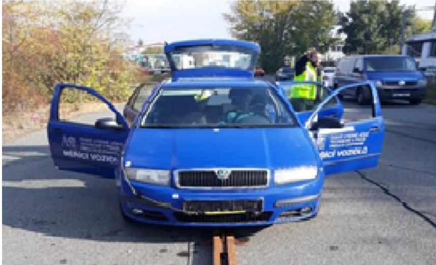
Obr.21 – ukázka vozidla Škoda Fabia a tažné vodící dráhy
