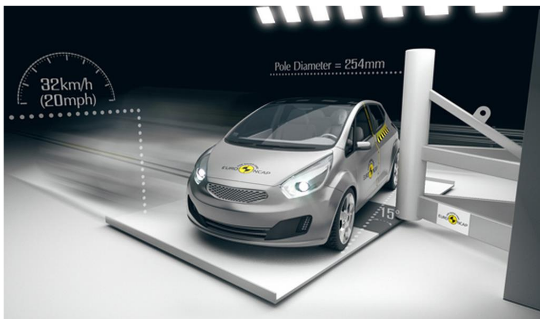
Obr. 13 - Ukázka automobilu při testu EURO NCAP, boční náraz do sloupu.
