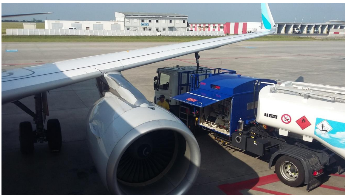
Obrázek 15 - Plnění LPH do letadla A320. Zde autocisterna může podjet křídlo letadla a plnit z levé strany. [Zdroj : vlastní]
