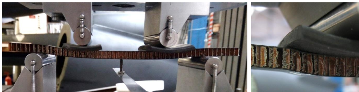
Obrázek 3.19: Porušení voštinového jádra při čtyřbodovém ohybu
