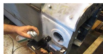
Obrázek 39 Provádění magnetické zkoušky
