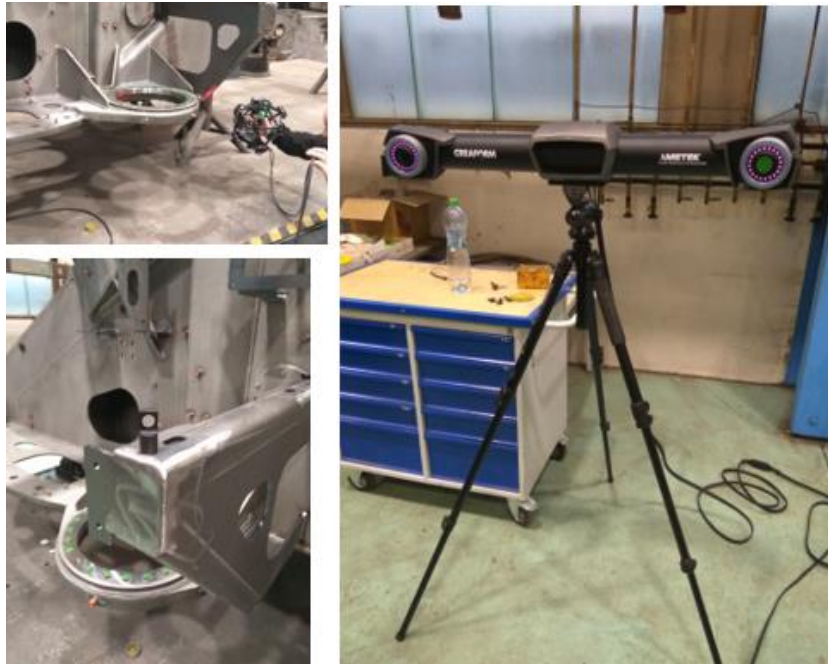
Obrázek 42 Provádění měření pomocí přístroje metraSCAN 3D
