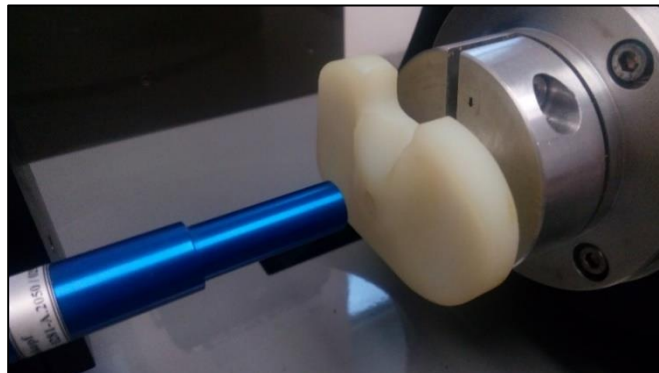
Obr. 21. Skenování tibiální vložky
