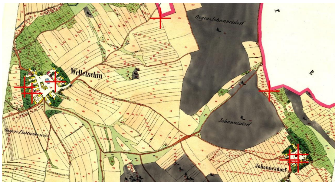
Obr. 13: Červené křížky ukazují rozmístění identických bodů (císařský otisk SK)
