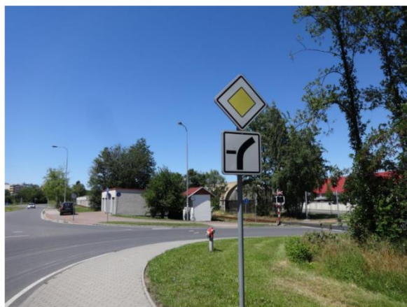
Pohled na nevhodnou dodatkovou tabulku SDZ E 10 "Tvar křížení pozemní komunikace s dráhou" pod SDZ P 2 "Hlavní pozemní komunikace"
