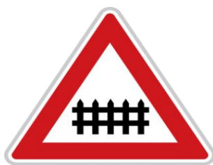
Obrázek 3 - SDZ A 29 „Železniční přejezd se závorami“ [32]
