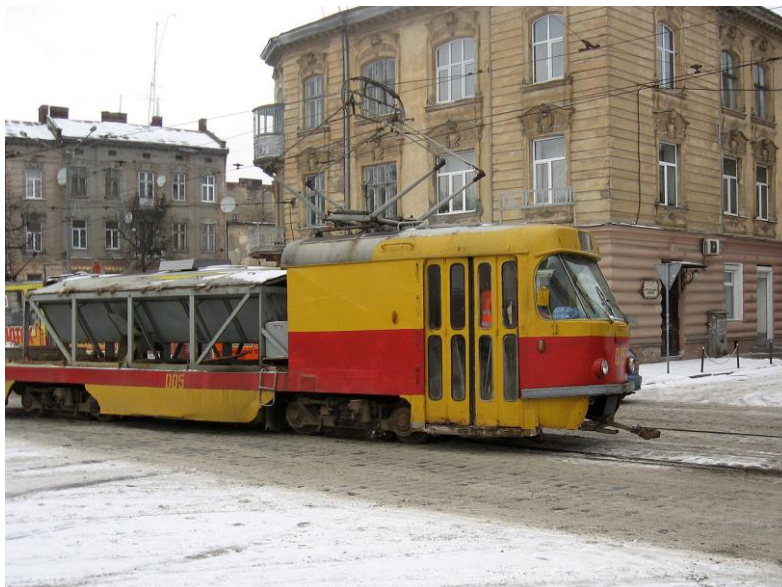
obr. 6 Tatra T4 přestavěná na nákladní tramvaj ve Lvově
