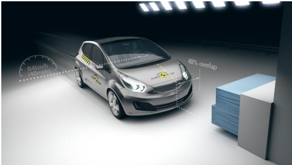
Obr. [2] Znárodnění čelního nárazu do deformovatelné překážky s překrytím 40%
