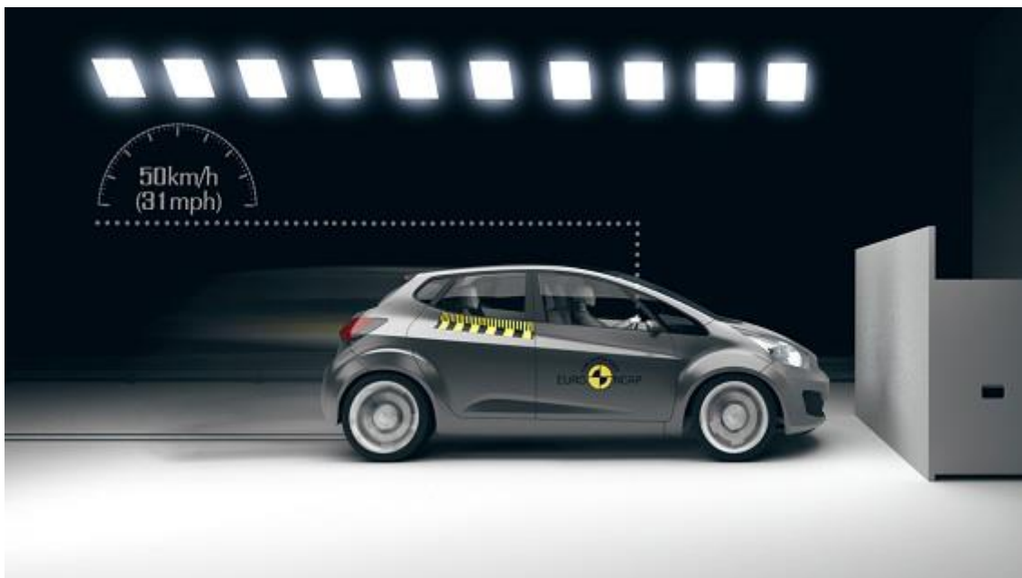
Obr. [3] Znárodnění řelního nárazu do nedeformovatelné překážky s překrytím 100 %.
