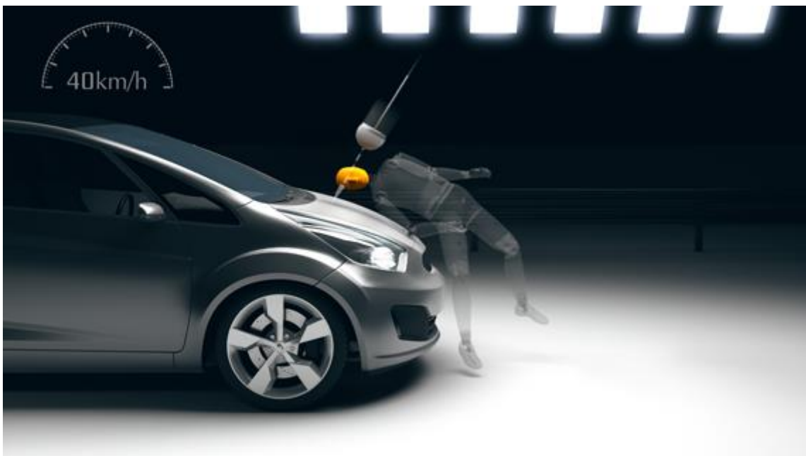
Obr. [5] Příklad nárazové zkoušky pro ochranu chodců, konkrétně průběh testu úrazu hlavy chodce při střetu s vozidlem jedoucím rychlostí 40 km/h.
