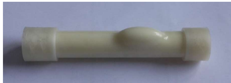
Obrázek 23 - Kopyto ve tvaru stenovitěho aneurysmatu vytištěného z PVA materiálu na 3D tiskárně
