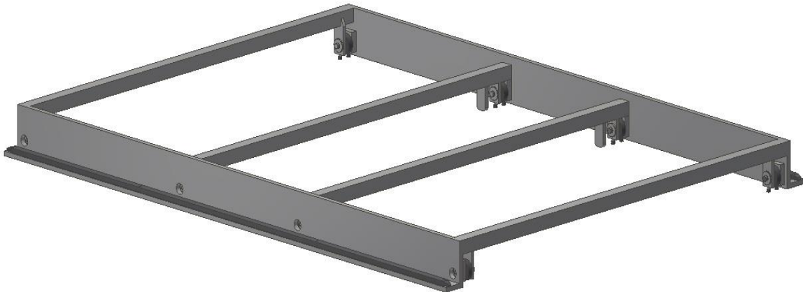
Obr.42.: Výsledná konstrukce spojovacího mostu
