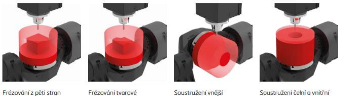
Obrázek 15 Technologické možnosti pětiosého obráběcího centra [10]
