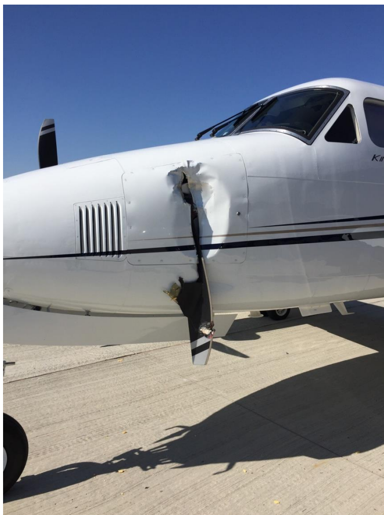
Obrázek 4: Zasažení trupu letounu King Air listem vrtule (12)
