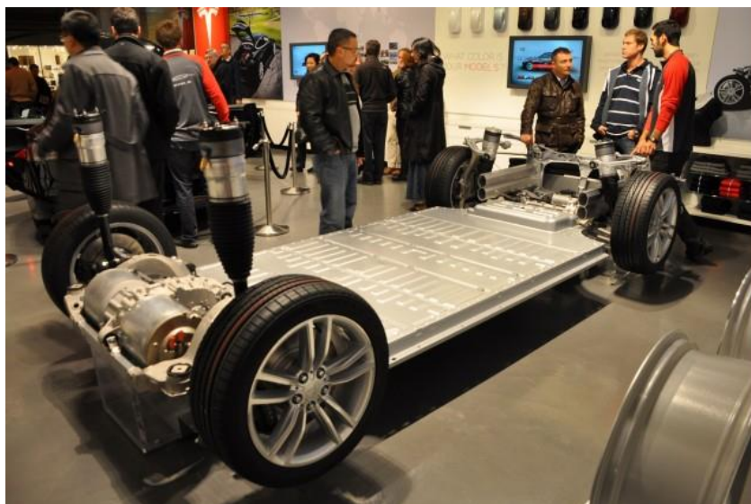
Obrázek 11.: Podvozek elektromobilu Tesla model S s lithium iontovou baterií, zdroj [16]
