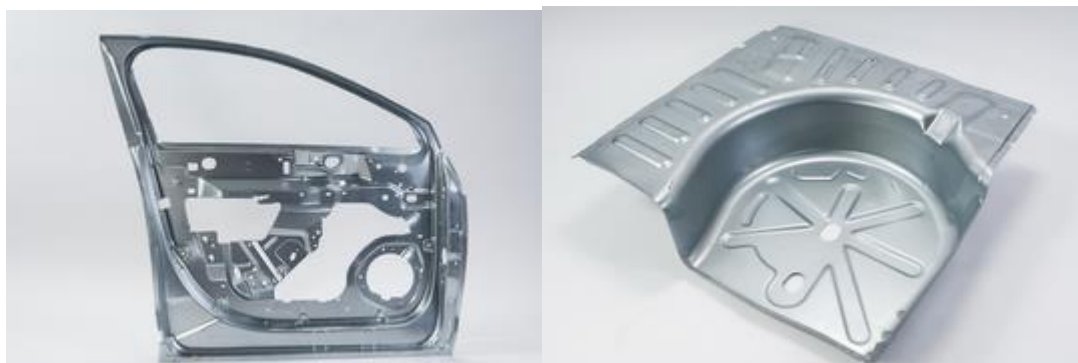
Obrázek 14 - Výtažek boku dveří a podlaha zavazadlového prostoru z materiálu DX54D
