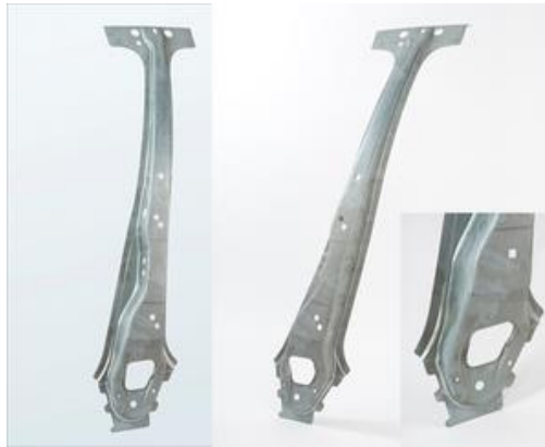
Obrázek 27 - Výztuha B-sloupku z materiálu TRIP 780
