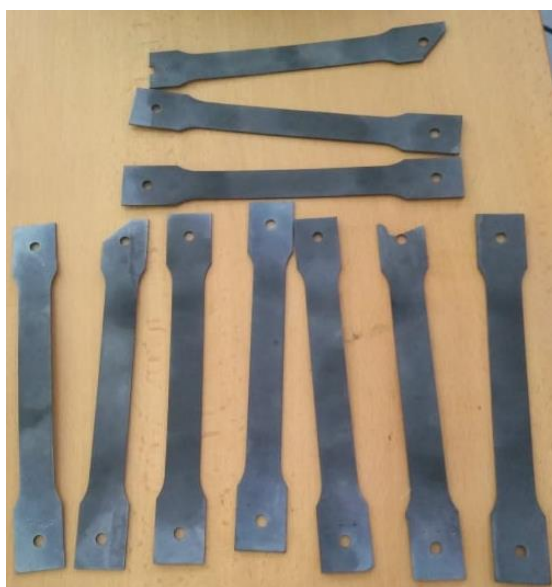
Obrázek 52 - Vzorky po tepelném zpracování
