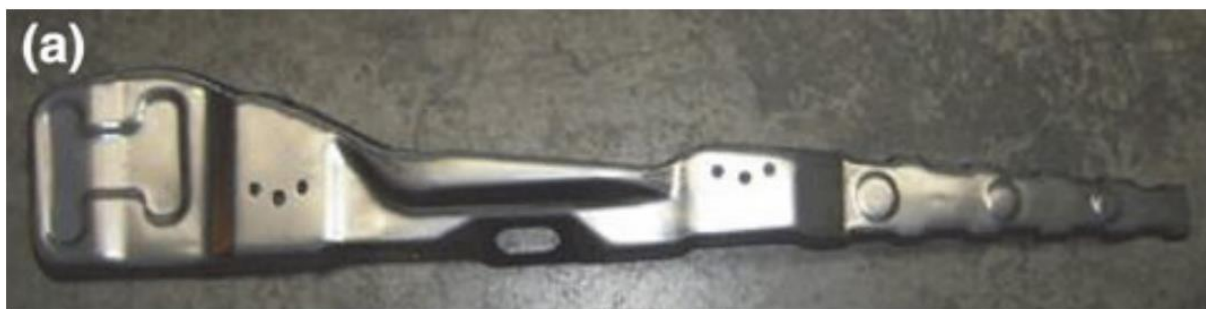
Obrázek 36 - Výztužná komponenta B sloupku z materiálu Q&P 980
