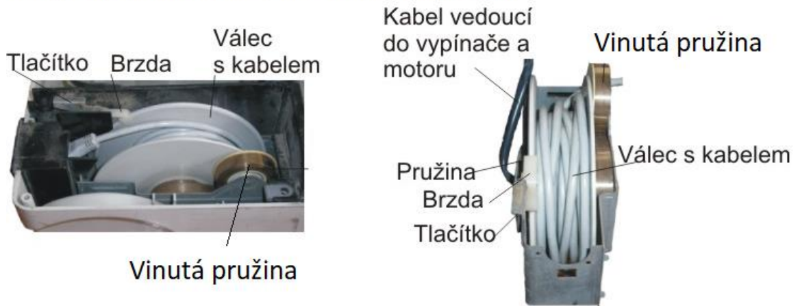
Obrázek 45: Schéma navíjecího systému ve vysavači [10]
