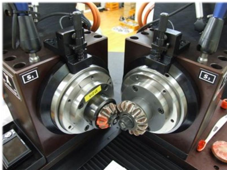
Obrázek 22: Metoda jednobokého odvalu [26]
