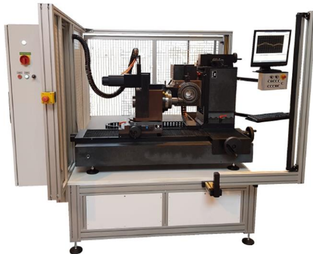
Obrázek 24: Měření dvoubokým odvalem [33]
