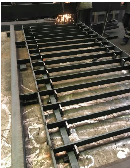
Obrázek č. 19. Fotografie přípravku pro ruční svařování
