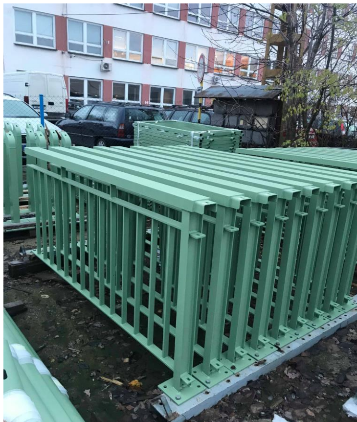
Obrázek č. 9. –Hotové mostního zábradlí typ A1
