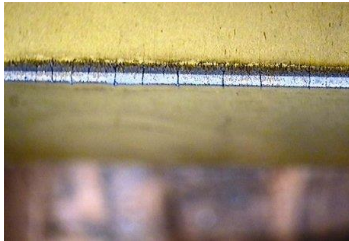
Obr. 13: Tepelné hřebenové trhlinky [21]
