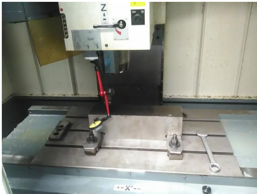
Obr. 24: Upnutí a vyrovnání obráběného materiálu
