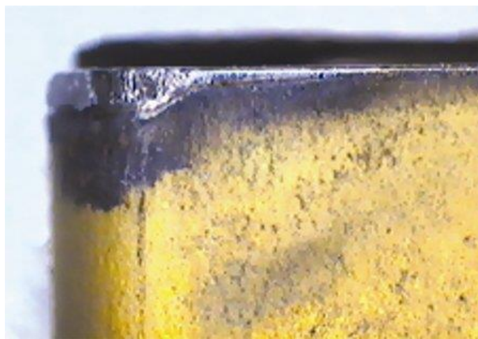
Obr. 9: Opotřebení na hřbetu nástroje [21]
